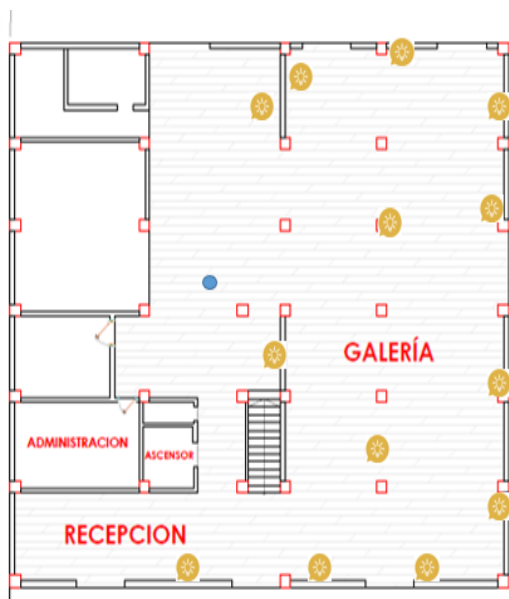
Ilustración 13. Propuesta. Sistema de iluminación. (Planta baja)
